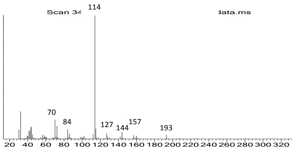
**Bis(diisopropylaminoethyl)disulfide (DESH-dimer).** RT=25.7 min; MW=320.
